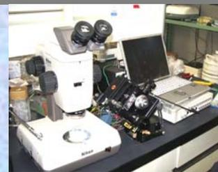
実体顕微鏡、マイクロマニピレーター、高速度カメラによるin vivoリアルタイムイメージング/マニピレーションを可能にしています
